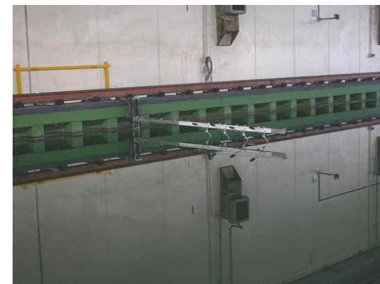
Sensori di livello per il rilievo della formazione ondosa
