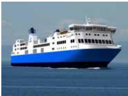
Il traghetto Gauthier costruito da Fincantieri per un armatore canadese è dotato di impianto di propulsione a Gas Naturale Liquefatto (per gentile concessione della rivista TTM).
